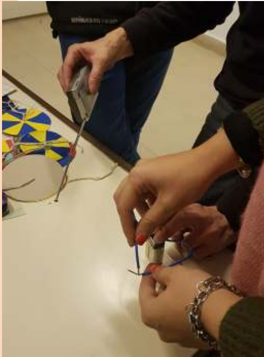
Figura 6. Detectando ondas electromagnéticas de baja energía con el detector adecuado: una radio.
