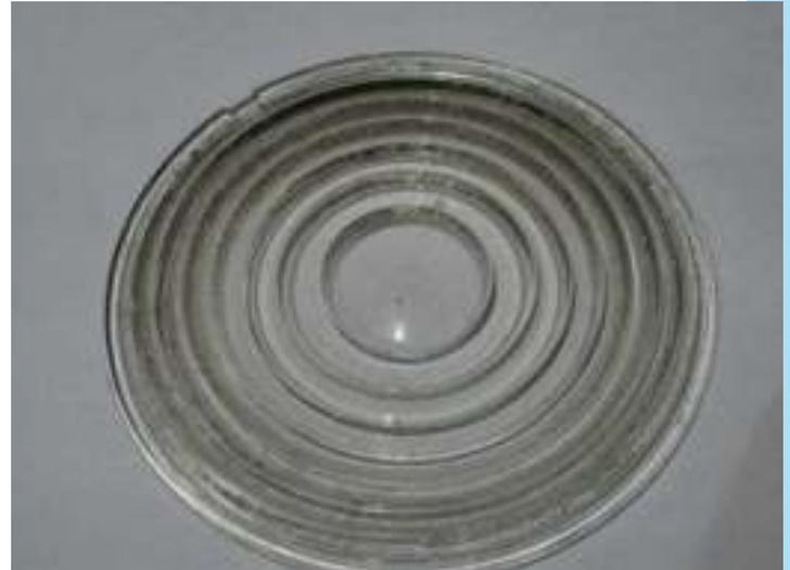
Figura 5. Luminaria de automóvil con Fresnel.
