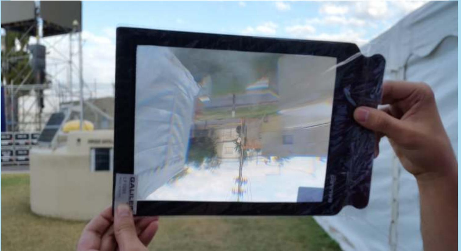
**Figura 7. Lente de Fresnel con Lupa: objeto más allá del foco de la lente (real, invertido, de menor tamaño).**
